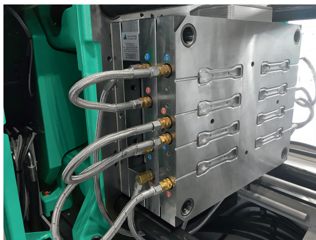
Bild 1. Untersuchungen zur Schmelzekompression dienen als Grundlage für eine fundierte Auslegung von Heißkanal, Spritzeinheit und Maschinengröße. Hier das verwendete Versuchswerkzeug
